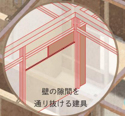
壁の隙間を通り抜ける建具
